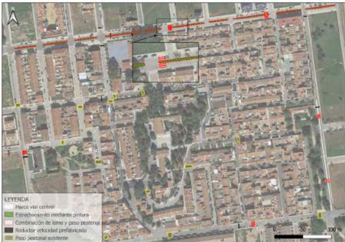
Ilustración 56. Ubicación de las recomendaciones de los elementos de calmado del tráfico. Fuente: Elaboración propia.
