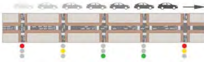
Ilustración 52. Esquema de la interrupción de la onda verde. Fuente: Municipalidad de la Ciudad de València, 2020
