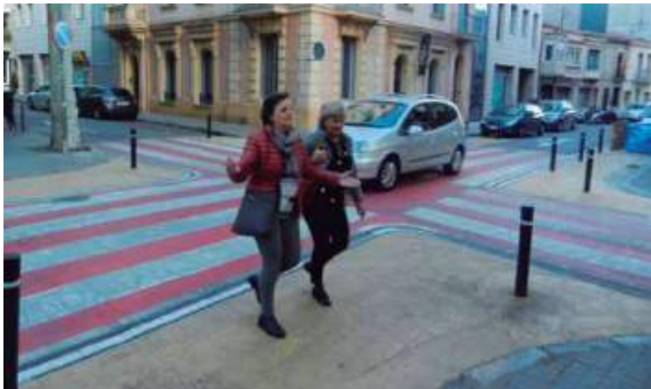
Ilustración 44. Orejas (prolongación de la acera). Fuente: DGT, 2019
